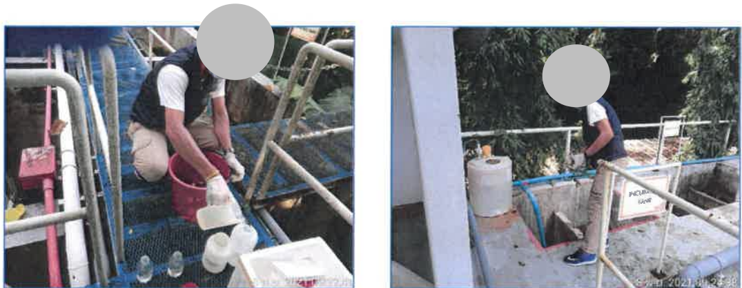
ภาพถ่ายที่ 3.4.5-1 การตรวจวัดคุณภาพน้ำทิ้งจากบ่อพักน้ำทิ้ง
